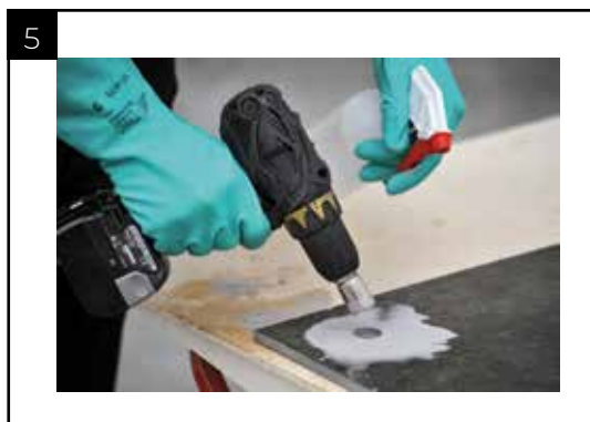
5. FORETTO DIAMANTATO PER FORATURA AD UMIDO 5. Diamond tool for wet drilling 5. Foret diamanté pour un perçage par voie humide 5. Diamantnassbohrer 5. Алмазное корончатое сверло для влажного сверления
