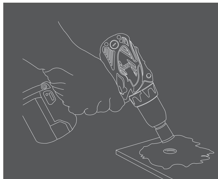
Foret diamantato per foratura ad umido - Diamond tool for wet drilling
