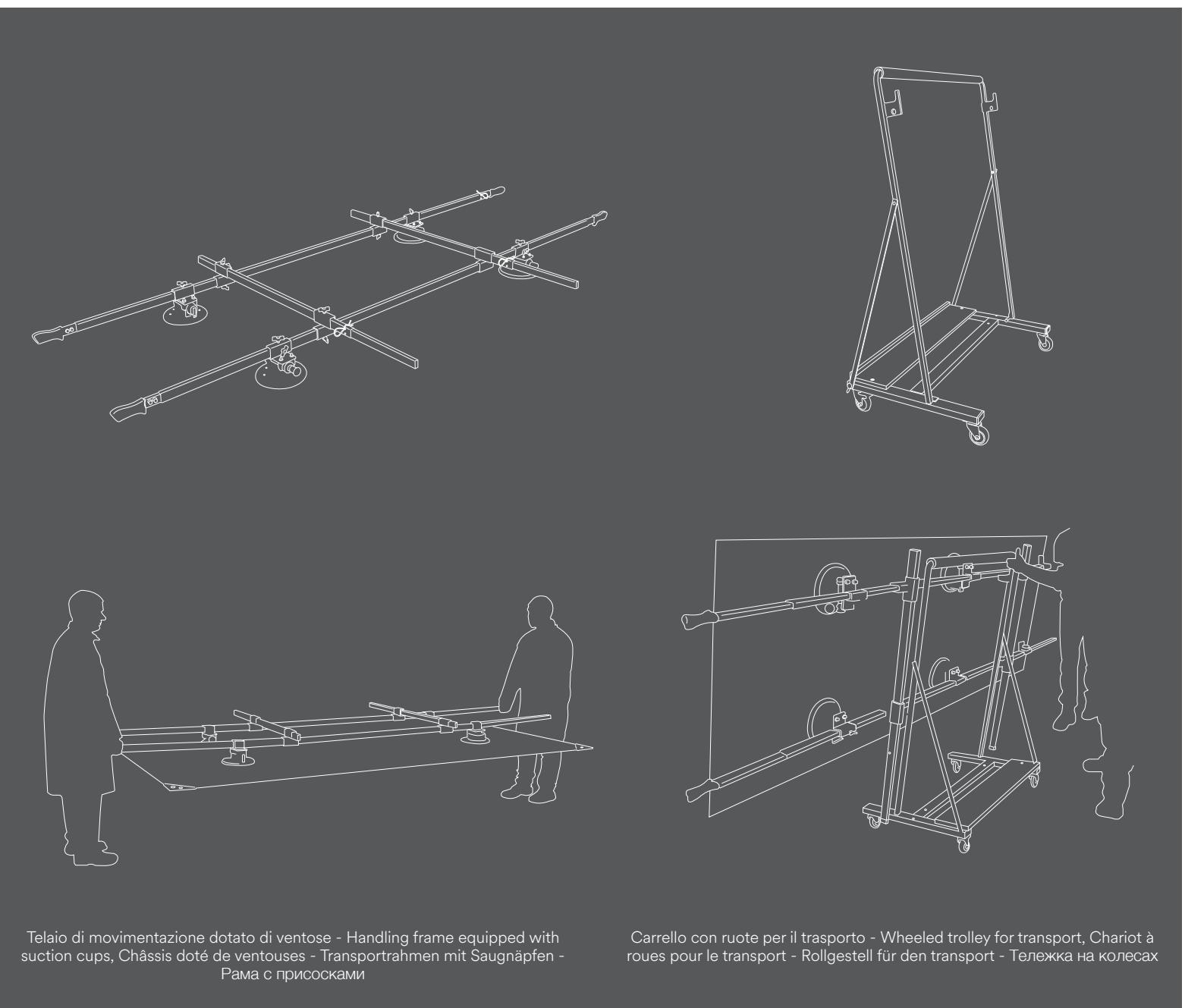
Telaio di movimentazione dotato di ventose - Handling frame equipped with suction cups, Châssis doté de ventouses - Transportrahmen mit Saugnäpfen - Рама с присосками
