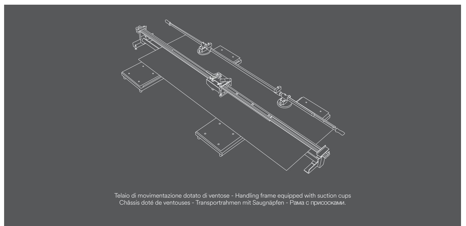
Telaio di movimentazione dotato di ventose - Handling frame equipped with suction cups
